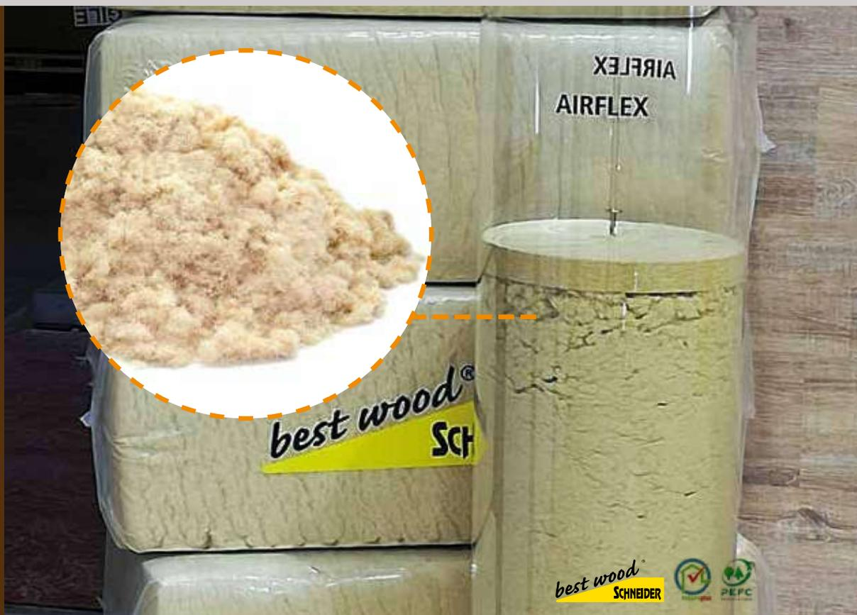
Fiocchi in pura fibra di legno naturale, composti da fibre di legno di conifera, additate con fosfato di ammonio (additivo di protezione antincendio). Conducibilità termica  $\lambda D = 0,039 \text{ W/mK}$ , densità di installazione ad appoggio libero  $28 \text{ kg/mc}$ , densità di installazione riempimento cavità  $35\text{-}38 \text{ kg/mc}$ .
